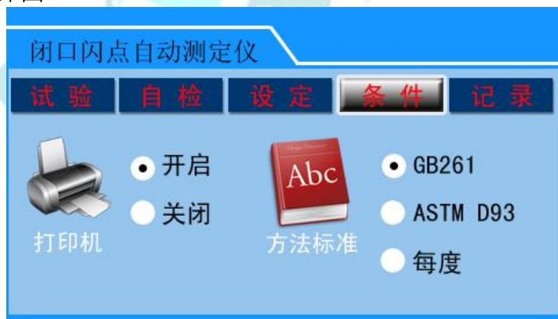
该界面用以设置打印机的开启、关闭及测试试样所符合的标准，采用的标准包括 GB261-2008 和 ASTM D93, 设定为“每度”时，测试试样开始后，在温度上升约 5°C 时，每升高 1 度即开盖并点火一次，试验试样是否闪火，适用于并不确知闪点范围的试样。
