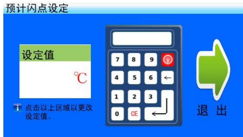
该界面下，点击“设定值”区域，键盘上方预计闪点设定值输入框处光标闪烁，可以输入数字，并按“ $\leftarrow$ ”确认输入。要删除输入的数字，可以点击“ $\leftarrow$ ”。点击右上角的“X”，退出预计闪点设定界面。
