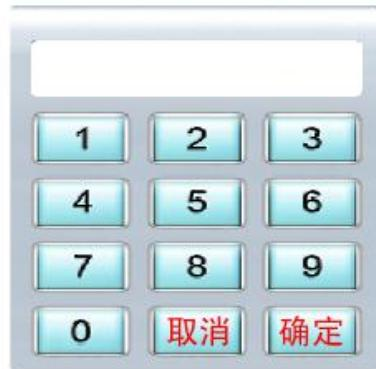
要调整日期、时间时，点击该界面上方的时间显示区域，键盘输入框中即有待修改时间显示(年、月、日、时、分、秒显示区域以“？”代替)，需要按顺序逐个输入，待秒数字输入后，可点击“确定”按钮完成修改。如中途退出，请点击“取消”。
