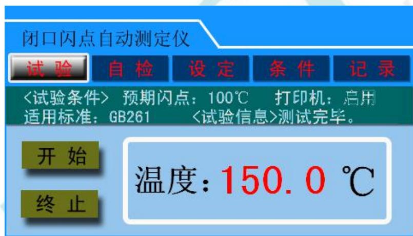
点击“开始”，测试臂落下，开始测试；点击“终止”，停止试验，测试臂升起。“试验条件”处显示测试的设定条件，包括预期闪点、打印机开关设置、试验所适用的标准等。“试验信息”处显示试验的进程信息。
